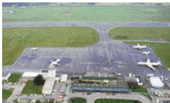
Brest-Guipavas - Piste principale et aires de stationnement en structure souple
