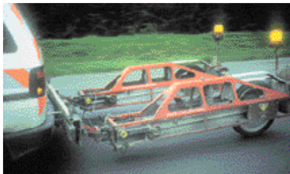
Mesure du défaut d'uni par analyseur de profil en long
