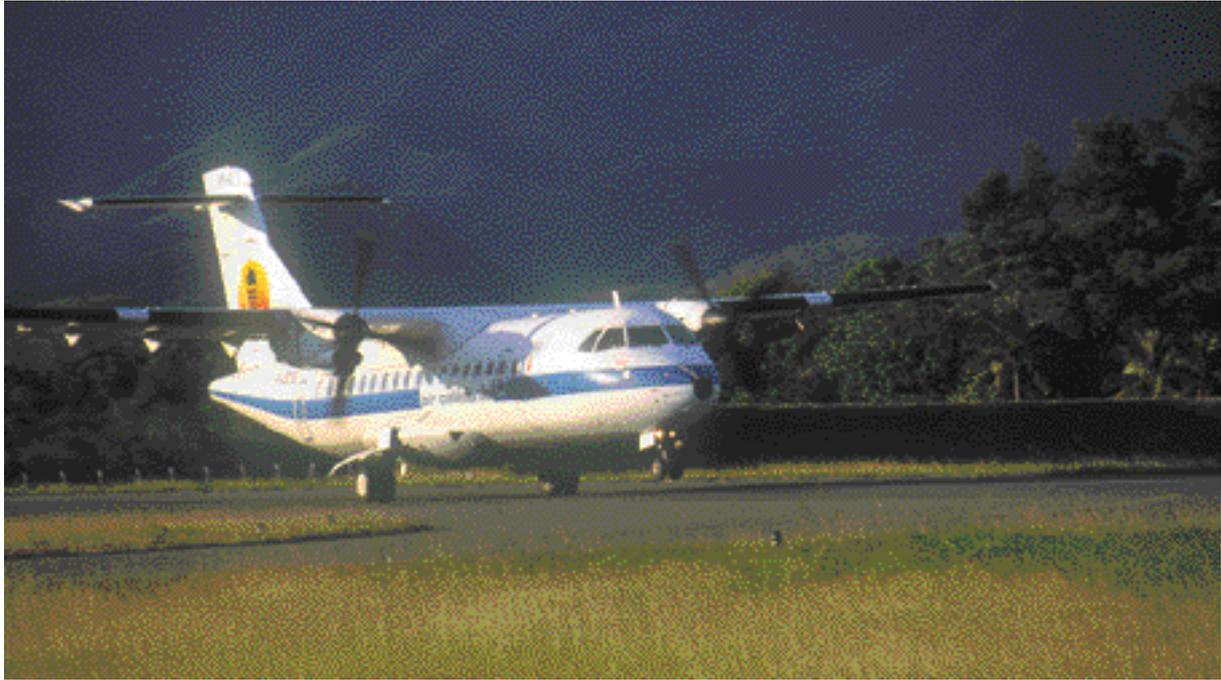
ATR 42 ( A.C.N. (B)  $_{max}$  : 9 ) d'Air Calédonie utilisant la piste ( P.C.N. ( F.B.W.T. ) : 26 ) de l'aéroport Nouméa-Magenta.
